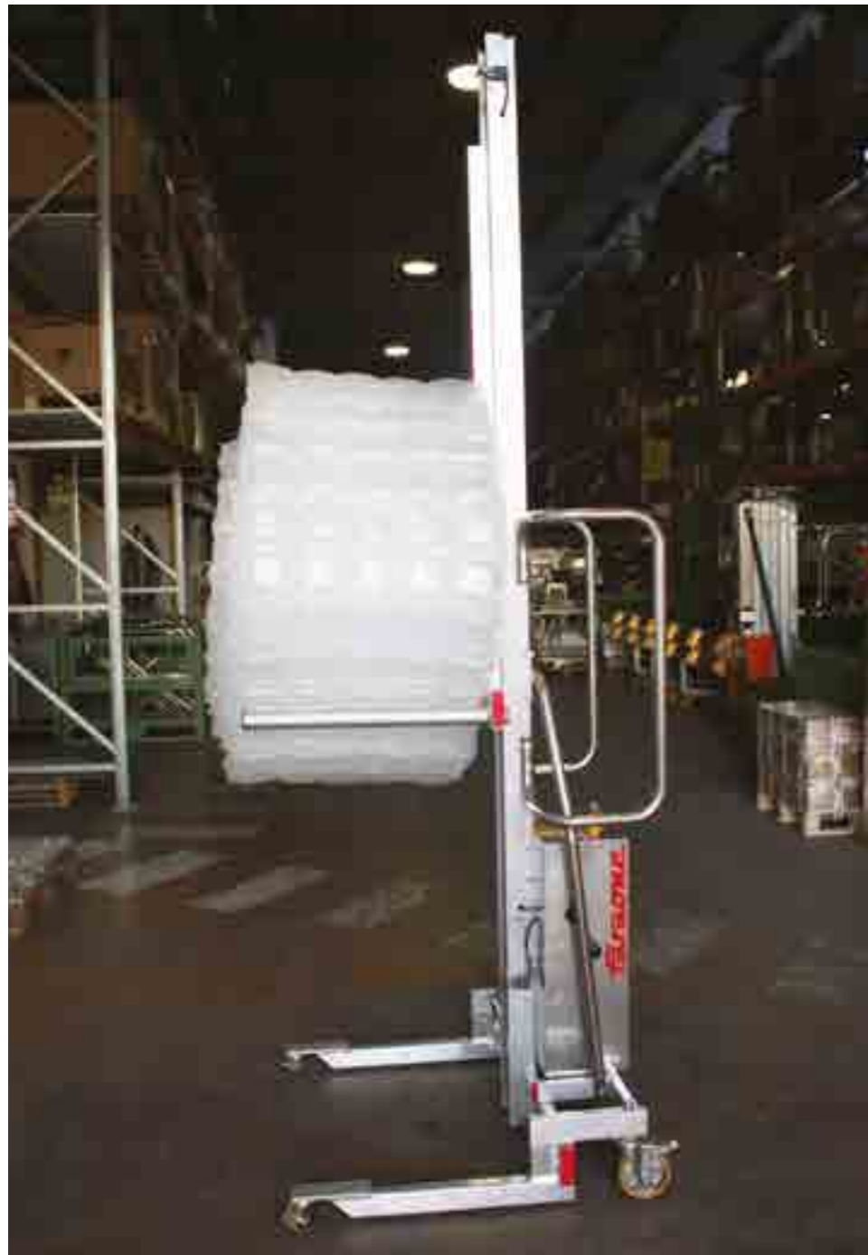
Speciale base bassa per accesso facile/pallet. Special low base for easy access/pallets.
