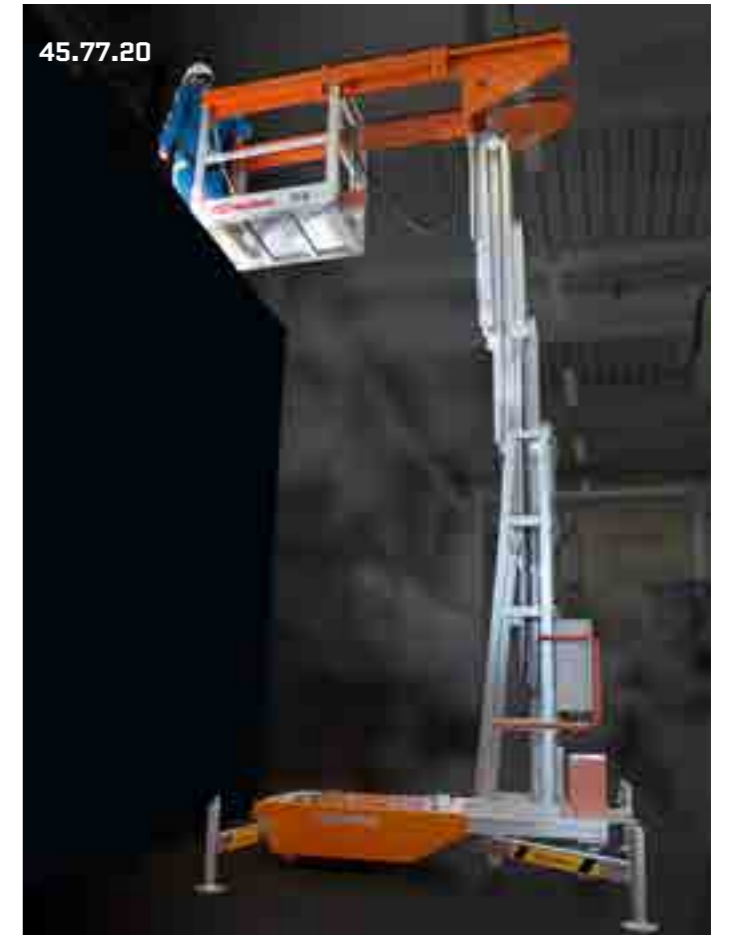
Piattaforma per sbarco in quota per 2 operatori. Omologata dal TÜV. Platform for exit at height for 2 operators. Homologated by the TÜV.
