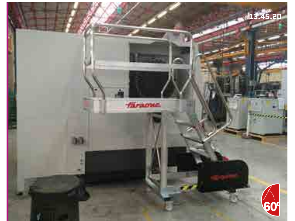
Scala a sbalzo frontale con base compatta. Front cantilever staircase with compact base.
