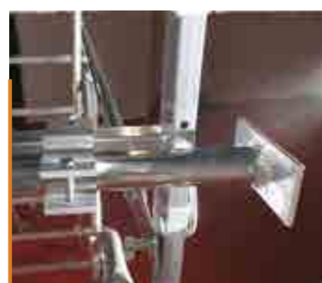
Staffa per ancoraggio a parete. Bracket for wall anchoring.
