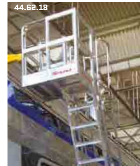
Scala a sbalzo per manutenzione motrici. Cantilevered ladder for tractor maintenance.
