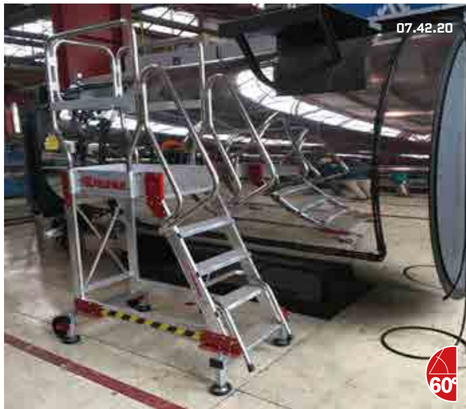
Scala a castello con sbarco frontale, base quattro ruote più maniglie. Bunk ladder with front landing, four wheel base plus handles.
