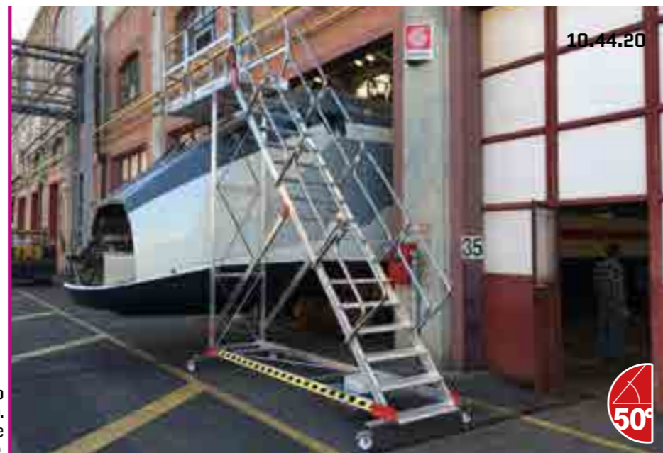
Scala a sbalzo frontale con base a quattro ruote con freno. Front cantilevered staircase with four-wheel base with brake.
