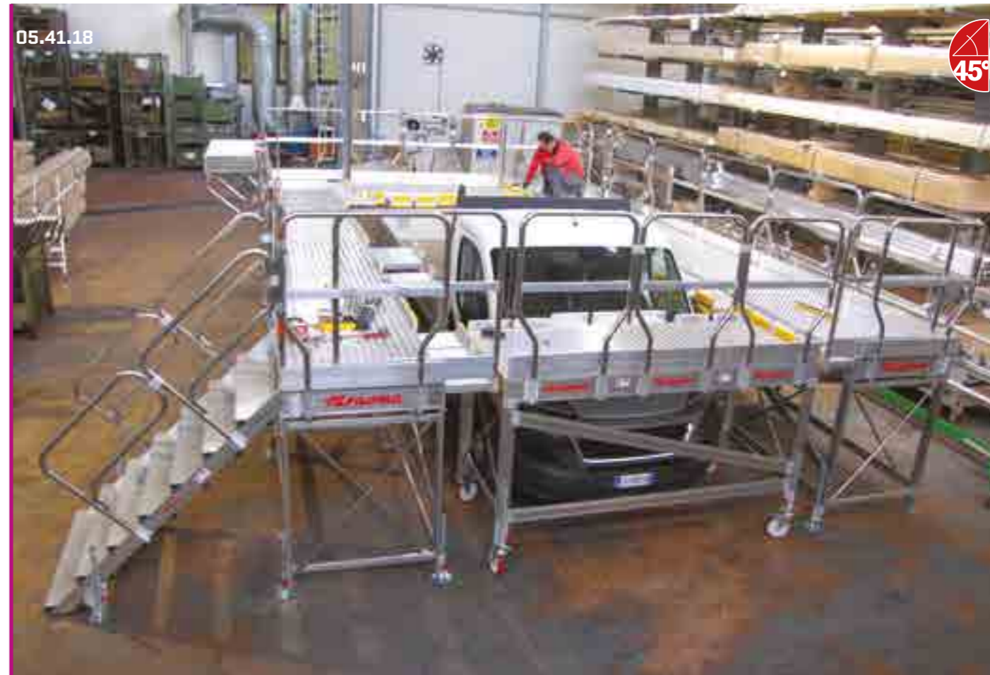
05.41.18 Scala System speciale con sistema di regolazione a cassette. "Scala system" with adjustment system with removable banks.
