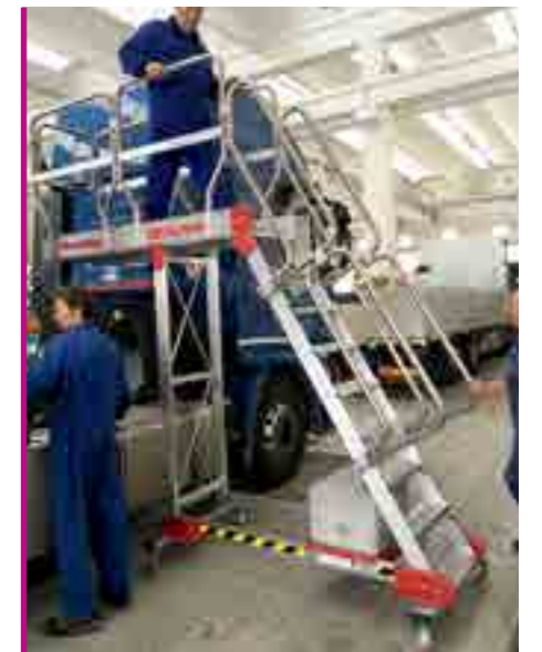
Scala a sbalzo per manutenzione motrici. Cantilevered ladder for tractor maintenance.
