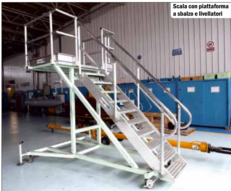
Sgabello speciale con ruote auto-disattivanti
