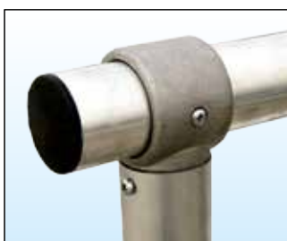
Parapetto realizzato in tubo Ø 50 mm con giunzioni in fusione di alluminio anti-ruggine fisse o snodabili per consentire cambi di direzione e di quota.
