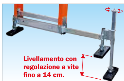
Basetta telescopica con chiusura a scomparsa e piedi basculanti che si adattano al terreno; dotata di n°1 piede livellatore in acciaio zincato con regolazione a vite che può essere montato e smontato all'occorrenza per colmare pendenze o dislivelli con facilità e precisione
