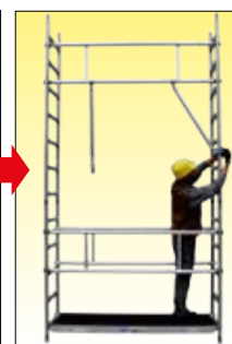
Libera i tiranti aprendo i morsetti e poi stringili sui tubi verticali
